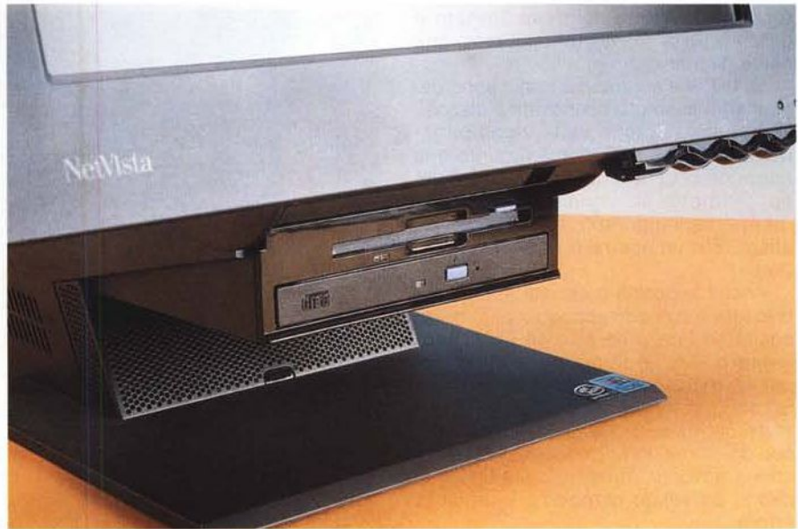
Il cassetto che ospita i drive di CD e floppy è a scomparsa: discende con un meccanismo a molla solo quando si preme il pulsante di sblocco sulla cornice del display.
